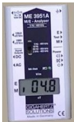
Sur la faille, la valeur moyenne est de 4,8 nT, soit une baisse de 33% de l'induction du champ magnétique terrestre.
