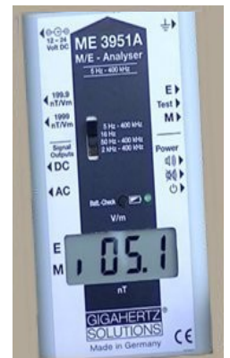
Sur le nœud, la valeur moyenne est de 5,1 nT, soit une baisse de 30,47% de l'induction du champ magnétique terrestre.
