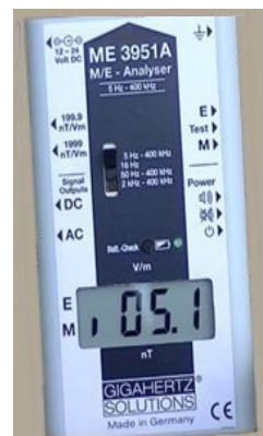
Sur le nœud, la valeur moyenne est de 5,1 nT, soit une baisse de 30,47% de l'induction du champ magnétique terrestre.
