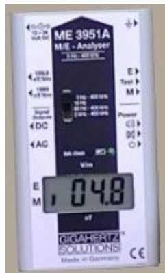
Sur la faille, la valeur moyenne est de 4,8 nT, soit une baisse de 33% de l'induction du champ
